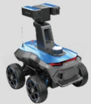
TS200户外轮式巡检机器人，高通过性设计，推荐用于220KV及以上变电站场景。
