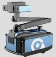
IW300室内轮式巡检机器人，可升降式设计，推荐用于配电房等室内场景。
