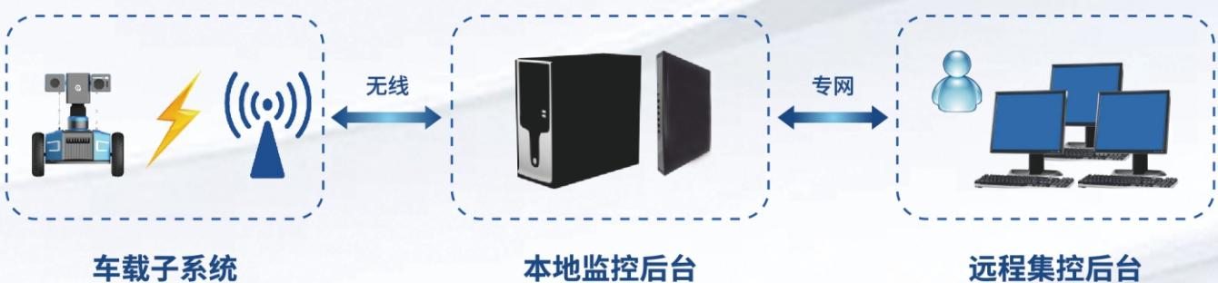
智能巡检机器人系统由车载子系统、本地监控后台及远程集控后台组成。车载子系统与本地监控后台进行采集数据、图像、视频的交互,远程集控后台实现集中式的状态监控及数据管理。
