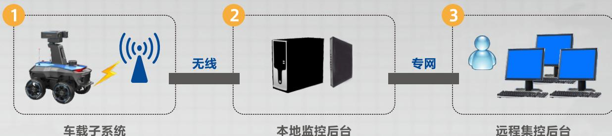
智能巡检机器人系统由车载子系统、本地监控后台及远程集控后台组成。车载子系统将采集到的数据、图像、视频与本地监控后台进行交互，远程集控后台实现整体状态监控及数据管理。
