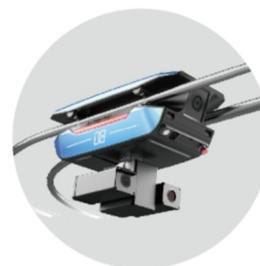
HR200双管系列轨道机器人，高防护设计，推荐用于输煤栈桥场景。
