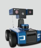
GS200户外轮式巡检机器人，小型化设计，推荐用于小型升压站场景。
