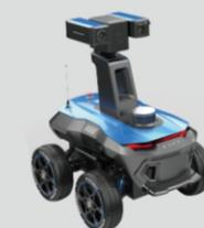
TS200户外轮式巡检机器人，高通过性设计，推荐用于大型升压站、主厂房场景。
