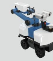
SC100轮式巡检机器人，多自由度设计，推荐用于复杂主厂房场景。
