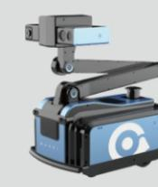
IW300室内轮式巡检机器人，可升降式设计，推荐用于化水车间场景。
