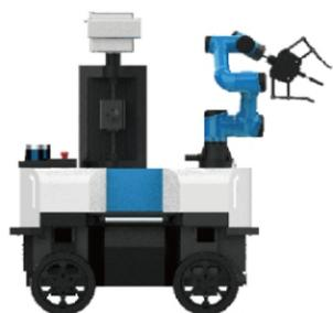
OR100智能操作机器人，通过搭载不同的末端，实现配电房场景的操作无人化。
